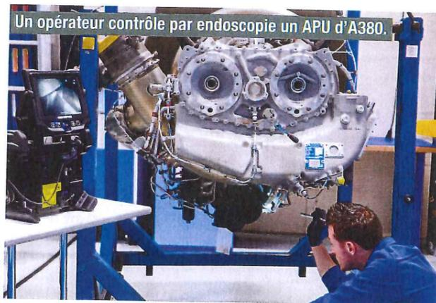
Un opérateur contrôle par endoscopie un APU d'A380.
